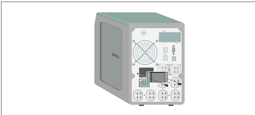
**注意:** 連接 EBM 和 UPS 時可能會出現少量電弧。這是正常現象，不會對人員產生傷害。將 EBM 纜線迅速穩固地插入 UPS 電池接頭中。
