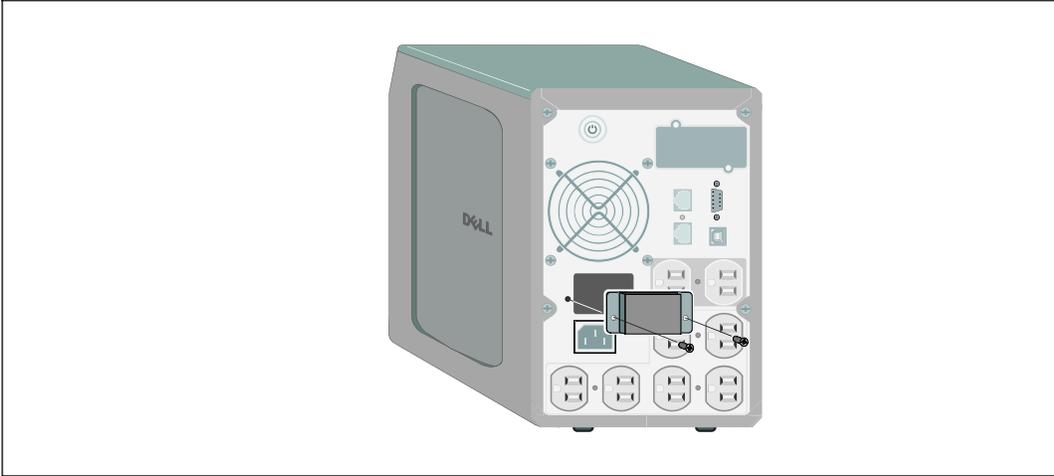
**注意:** 连接 EBM 和 UPS 时可能会出现少量火花。这是正常现象，不会对人员产生伤害。将 EBM 线缆迅速稳固地插入 UPS 电池连接器中。
